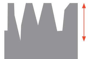
Handelsübliches Plastisol 60-100 µm Lederstruktur
